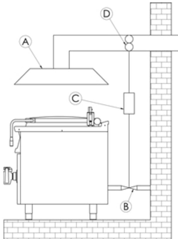
Vyústění digestoře je do samostatného komínového tělesa (A). Odtah spalin zabezpečuje přirozený tah komínu.
